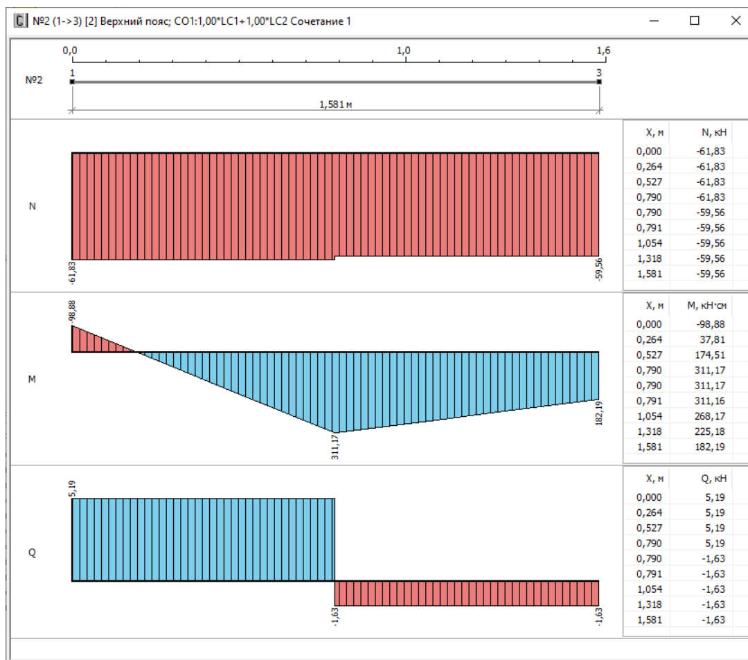
Рисунок 7.3.5 – Эпюры и значения усилий для элемента 2
